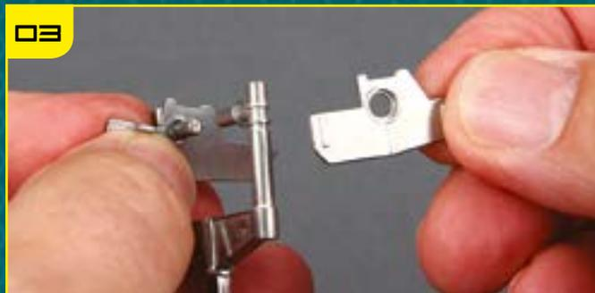
Наденьте правую монтажную пластину на другой штифт. Она должна располагаться зеркально относительно первой пластины. Центрирующий выступ и здесь должен быть вверху с внутренней стороны.
