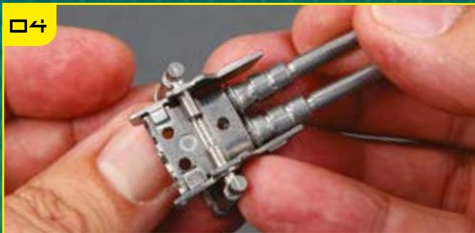
Осторожно удерживая собранную конструкцию, возьмите нижние стволы лазерной пушки и установите их так, как показано на фотографии: чтобы штифты детали 8 попали в проточенную для них канавку.
